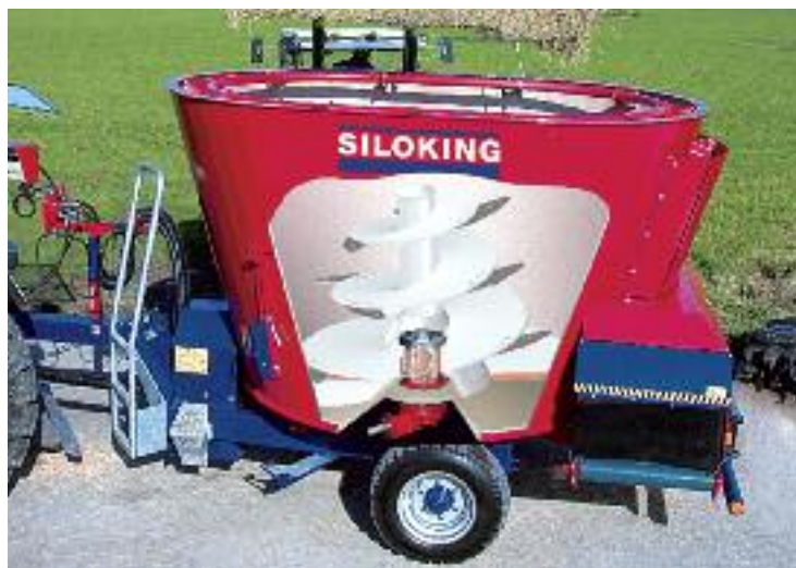
„Große Schnecke – kleine Drehzahl und scharfe Messer schonen die Futterstruktur beim Mischvorgang. Scharfe Messer sind nicht nur zum Auflösen von Ballen wichtig.“ Werkfotos
