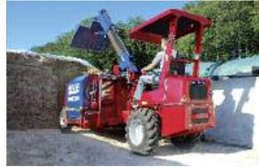
Der SILOKING-Silokamm-Selbstfahrer wird jetzt von einem neuen leistungsstarken Hydrostaten angetrieben. Werkfoto
