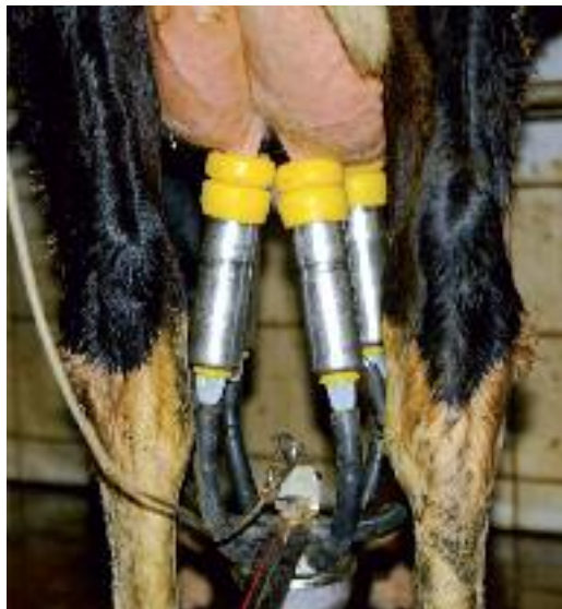
Bei schrägem Melkbechersitz steigen Melkdauer, Gewebelastung und Mastitisrisiko.
